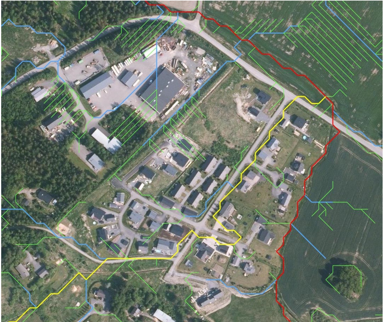
Kuva 5: Pintavesien virtausmalli suunnittelualueelta ja sen ympäristöstä, yläpuolinen valuma-alue, hehtaaria. Punaisella kohti Pyhäjärveä kulkeva uoma. Lähde: Suomen metsäkeskus.
